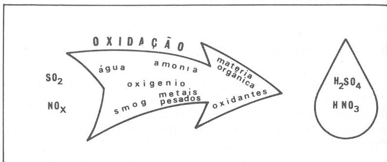
Fig. 19 — As reacções químicas na atmosfera podem converter dióxido de enxofre e óxidos de nitrogénio gasosos numa grande variedade de compostos, como os ácidos sulfúrico e nítrico. A radiação solar, a humidade relativa e a presença de oxidantes e de catalisadores todos concorrem para a formação de novos compostos.
